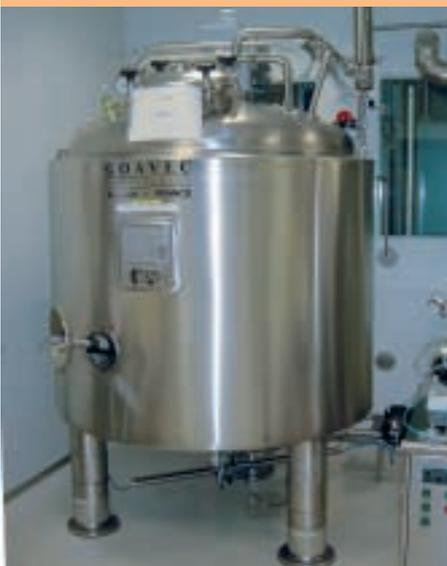
bereits vorhandenen Simatic Controllern entsprechend modifiziert und die Bedienoberfläche für den Pufferansatzbehälter im Prozessleitsystem Simatic PCS 7 implementiert.
